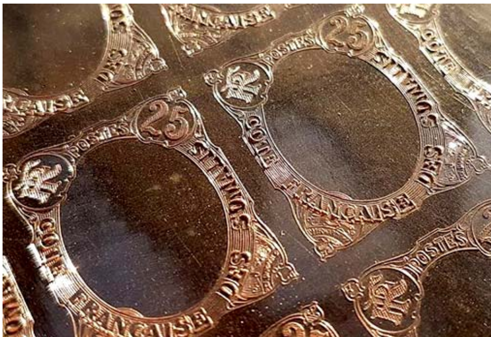
Photo d'une partie d'une plaque de cuivre, en relief, servant à la production de plaque d'impression
